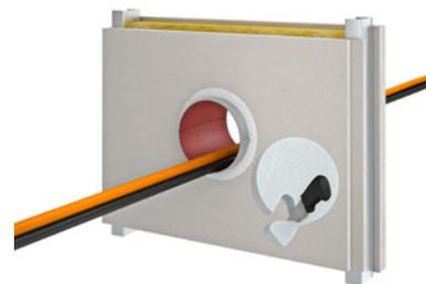
5. Stopfen komplett in Dicke  $\geq 2$  mm (TSD  $\geq 1$  mm) mit FLAMMOTECT-A oder BMK versiegeln.
